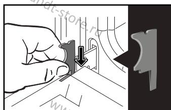
Используйте инструмент (отвертку), чтобы нажать на пазы А, чтобы отсоединить стеклянную панель. Снимите стеклянную панель.
