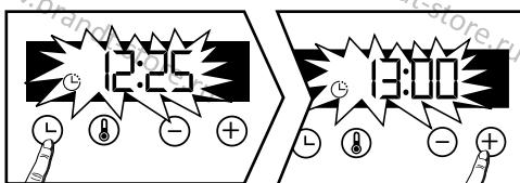
Дисплей мигает. Установите время окончания приготовления с помощью кнопок + и - .
