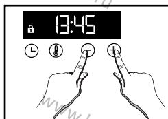
Нажмите + и - одновременно до тех пор, пока на экране не появится соответствующий символ. Чтобы разблокировать клавиатуру, нажмите + и - вместе до тех пор, пока символ не исчезнет с экрана.
